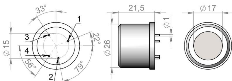
Рис.1 Размеры сенсора и схема расположения выводов
