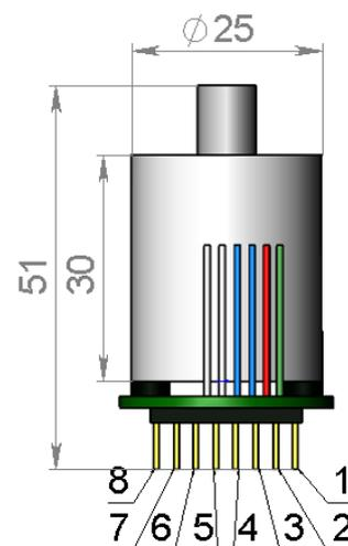
Рис.1. Сенсор кислорода с разъемом.
