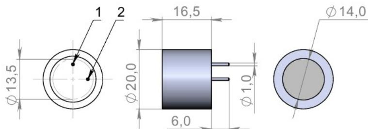
Рис.1 Размеры сенсора и схема расположения выводов
