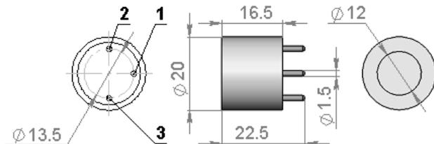
Рис.1 Размеры сенсора и схема расположения выводов
