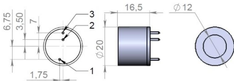
Рис.1 Размеры сенсора и схема расположения выводов
